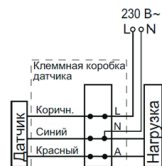
Рисунок 14 - схема подключения датчиков
