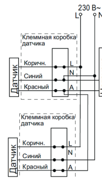
Рисунок 16 - схема параллельного подключения датчиков
